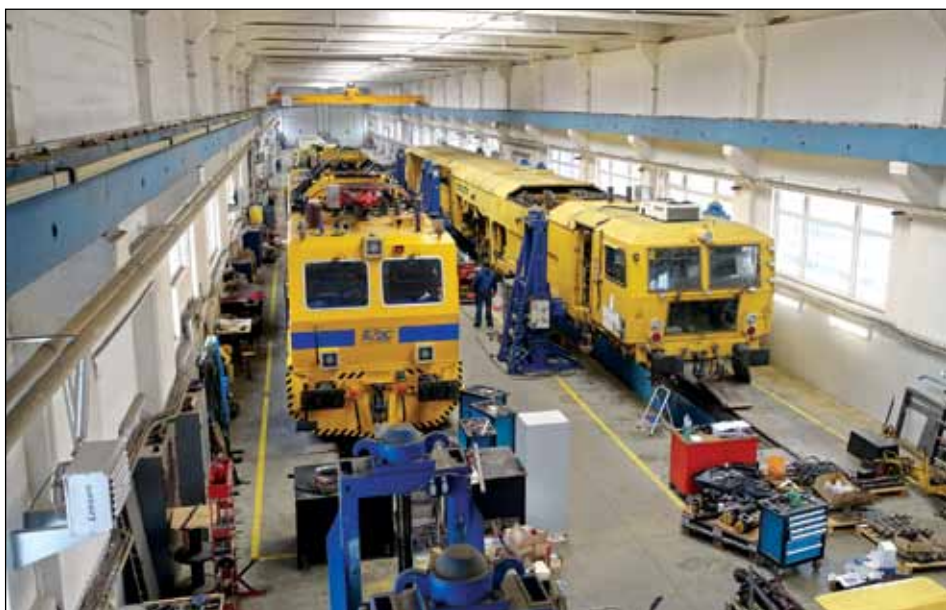
Zejména na opravy traťových strojů rakouského výrobce Plasser & Theurer se specializuje společnost VHC Servis, spol. s r. o., v jejíž lovosické hale se v prosinci 2022 podrobovala „zimní údržbě“ podbíječka UNIMAT 08-475/4S a na koleji vlevo probíhala montáž vozidlové části ETCS do vozidla MTW 100.13/7 Správy železnic.
