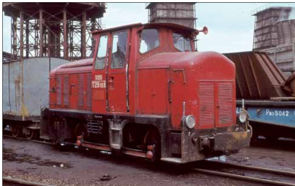
Snímek lokomotivy T 29.101 pořízený před expedicí z továrny SGP v roce 1960. Na obrázku je dobře patrný spojnicový pohon obou dvojkolí od jalového hřídele.
