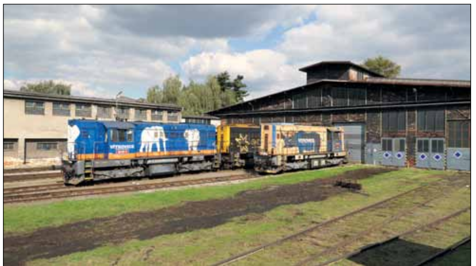
Dne 2. října 2025 už byly před halou depa Vítkovické dopravy koleje rozchodu 790 mm vytrhány, v jednom z vjezdů zbyl jen krátký kousek pro umožnění výjezdu posledních dvou lokomotiv a jejich zvednutí jeřábem z kolejí.
