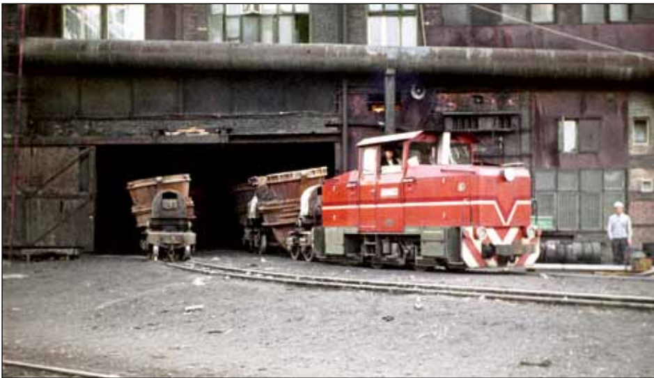
Lokomotiva DH200.0504 vyvází v říjnu 1974 z objektu ocelárny speciální struskové vozy, které sloužily k přepravě horké strusky od ocelářských pecí do mlýna na Thomasovu moučku, kde se z ní vyrábělo zásadité fosforečné zemědělské hnojivo.
