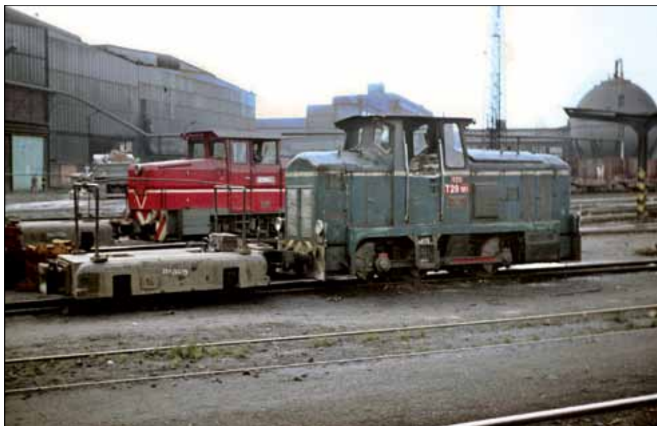
Atypicky zbarvená lokomotiva DH200 se soupravou korytkových vozů přepravující v tzv. korytkách vsázku do ocelářských pecí v říjnu roku 1974.
